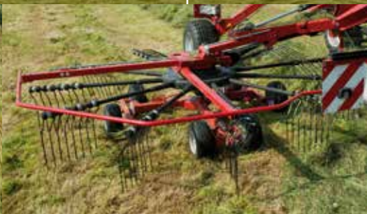
De stabiliteit van de rotor is het meest bepalend voor de capaciteit
