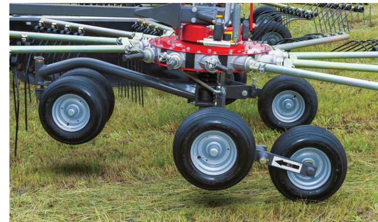
Gepatenteerde rotorophanging met volledig cardansysteem
